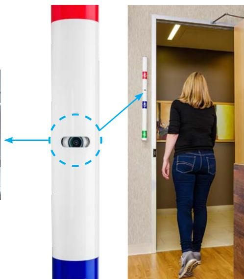
*Installez dans un boîtier avec jauge de hauteur pour des vues du visage parfaitement claires au niveau des yeux*
