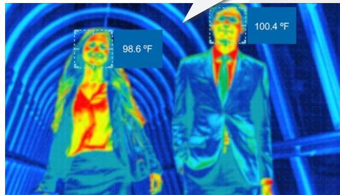
*A fin de mejorar la precisión, las cámaras térmicas deben instalarse de acuerdo a condiciones y procesos específicos.*
