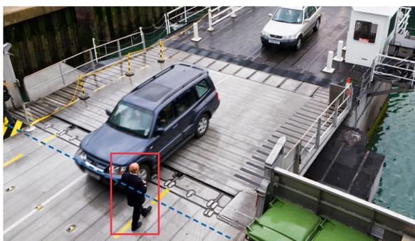
*L'analyse de "Mauvaise direction" déclenche une alarme lorsqu'une personne entre dans la zone d'accès restreint.*
