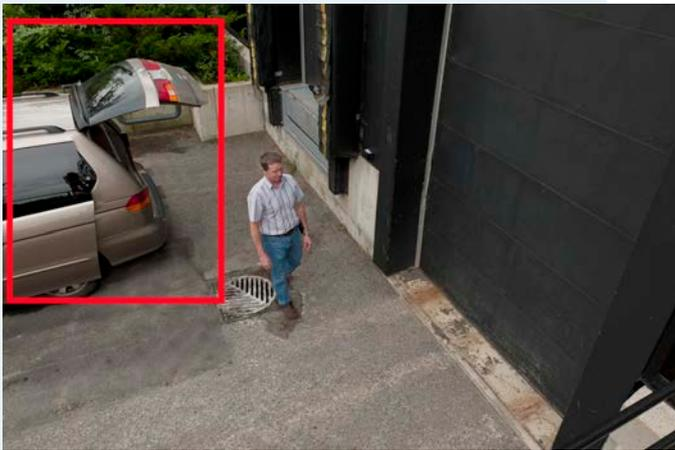
L'analyse « détection de vagabondage » déclenchée une alarme lorsque des personnes restent dans une zone trop longtemps.
