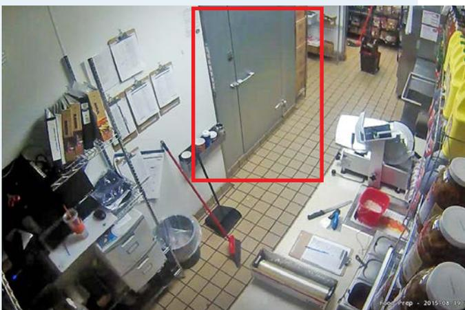
L'analyse « objet abandonné » déclenchée une alarme si un objet est ajouté à une zone spécifique. Dans l'exemple ci-dessus, tout nouvel objet bloquerait la porte.
