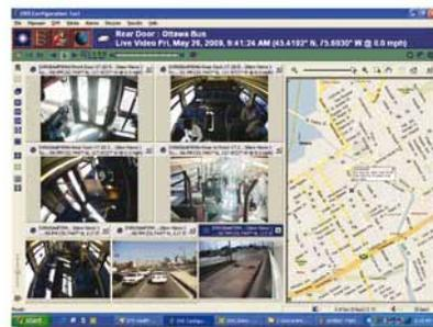
*O mapeamento baseado em GPS exibe a localização do veículo e sua velocidade em conjunto com o vídeo sincronizado.*
